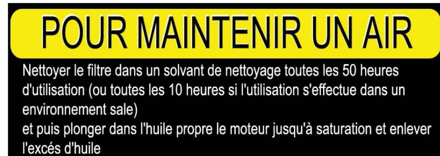
Etiquette d'instruction pour le nettoyage du filtre à air:
